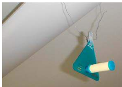
Mesure de débit de ventilation et mesure de COV par tube passif
